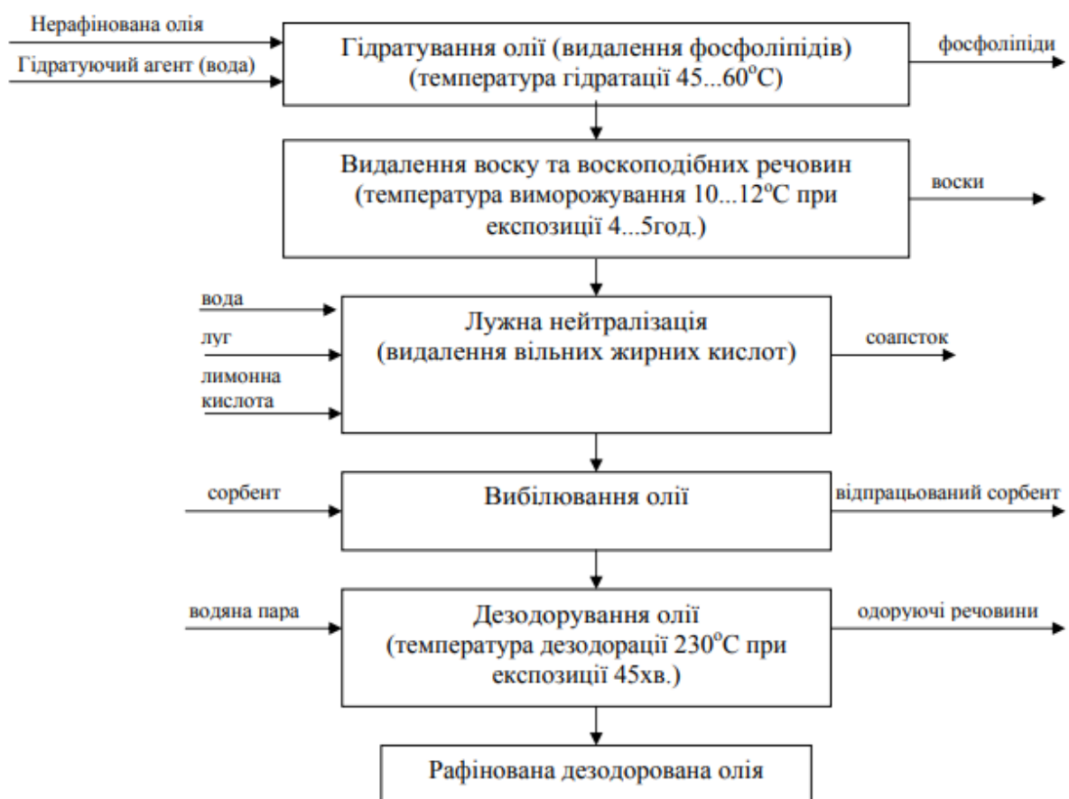
Рис 1.2. Блок-схема повного рафінування олії
